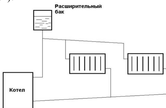
Рис. 1. Система отопления с естественной циркуляцией теплоносителя
